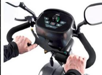
Einhandbedienung durch spezielle Fahrhebelwippe möglich!
