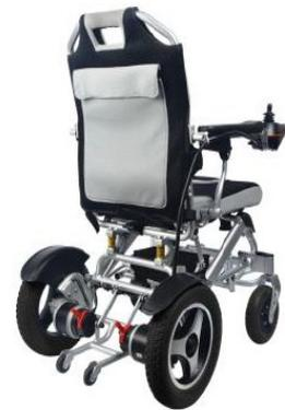
**HIGHLIGHTS:** Werkzeuglos faltbar, geringes Leergewicht, pannensichere Bereifung, Federung unter dem Sitzrahmen.
